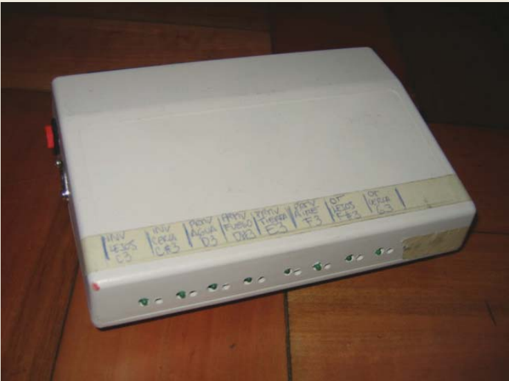
Fig.2: Unidad receptora de sensores, realizada por el ingeniero Randall Ledermann
